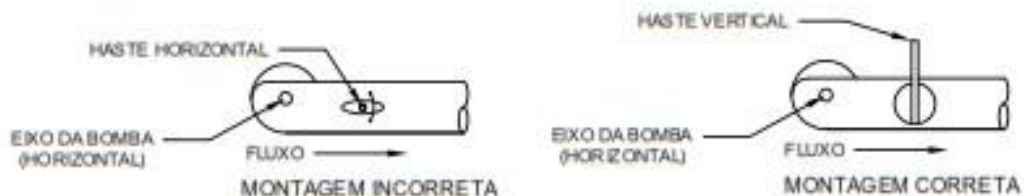
BOMBA CENTRÍFUGA COM EIXO HORIZONTAL E HASTE DA VÁLVULA NA VERTICAL
